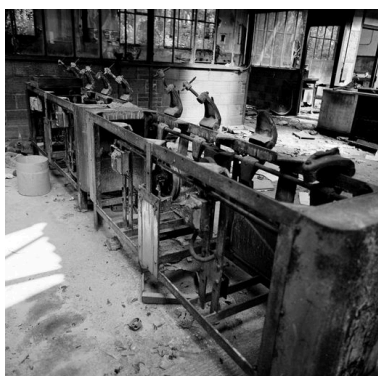
L'atelier de fabrication reconstruit après la guerre, banc de polissage. Phot. Patrick Glotain IVR22_19936000519X
