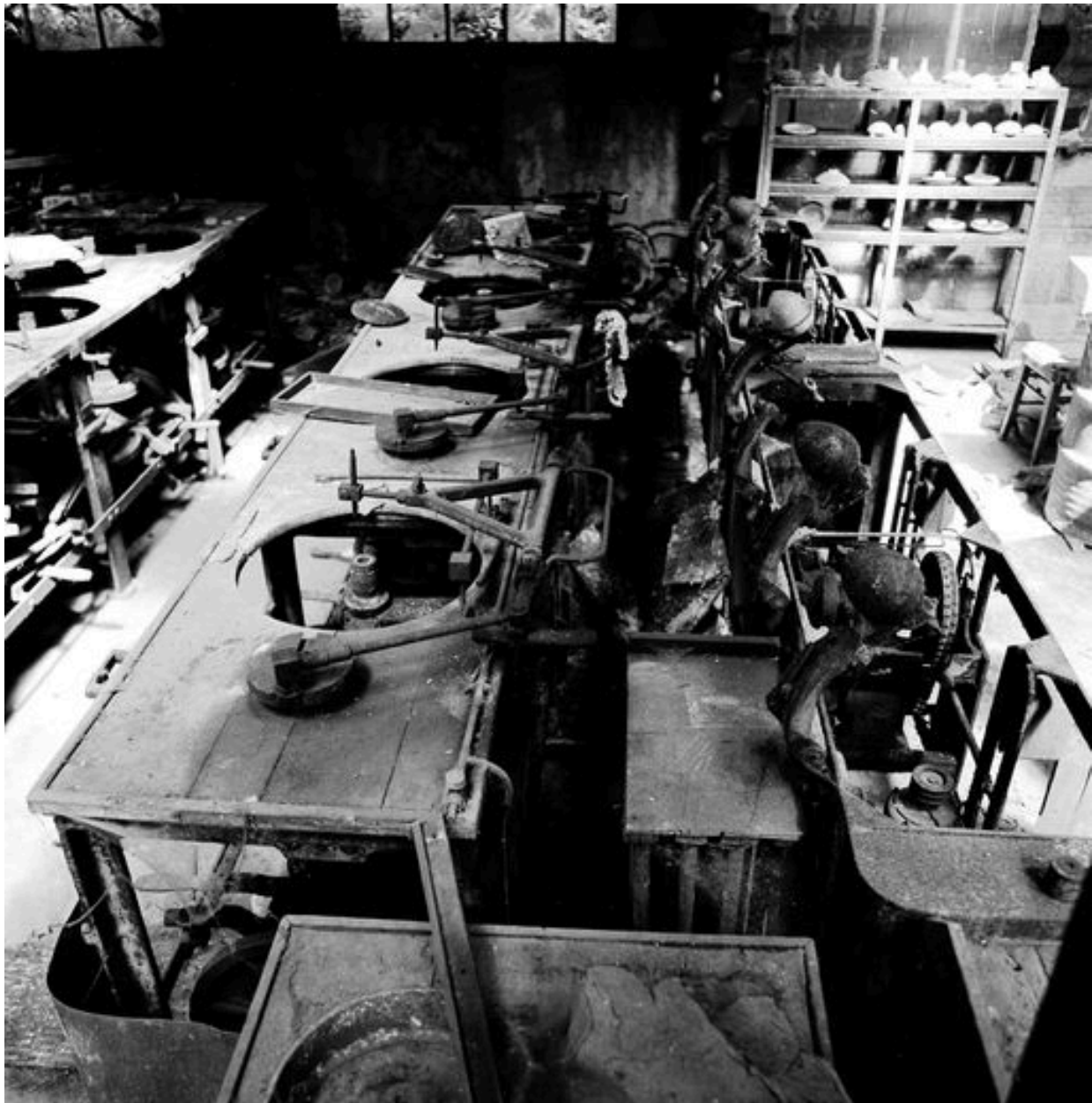
L'atelier de fabrication reconstruit après la guerre, banc de polissage.
