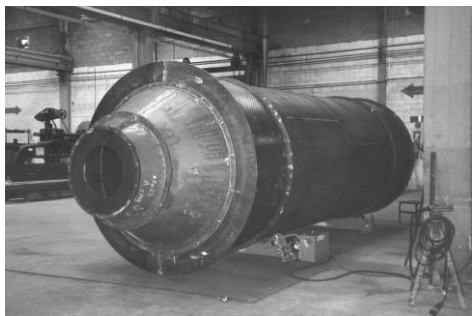
Gantois : un « trommel » de traitement d'ordures ménagères
