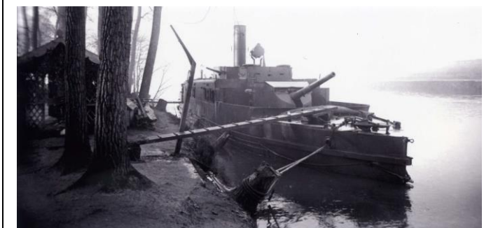
La canonnière « M » sur les berges de l'Oise est équipée de deux canons de 100 mm (un à l'avant et un à l'arrière) et de deux de 47 au milieu (Photo ECPA-D).
